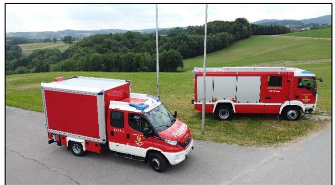
Durch die Beladung in Rollcontainer, welche für die jeweiligen Einsatzszenarien vorbereitet sind, und der Ladebordwand bietet das Kleinlöschfahrzeug Logistik eine vielfältige Verwendung, wie beispielsweise als Transportfahrzeug von Feldbetten bei einem Katastrophenfall. Über den Sommer 2023 wurden auf Grund dessen bereits zahlreiche Schulungen abgehalten, um für den Einsatzfall mit dem neuen Einsatzfahrzeug gut gerüstet zu sein.
